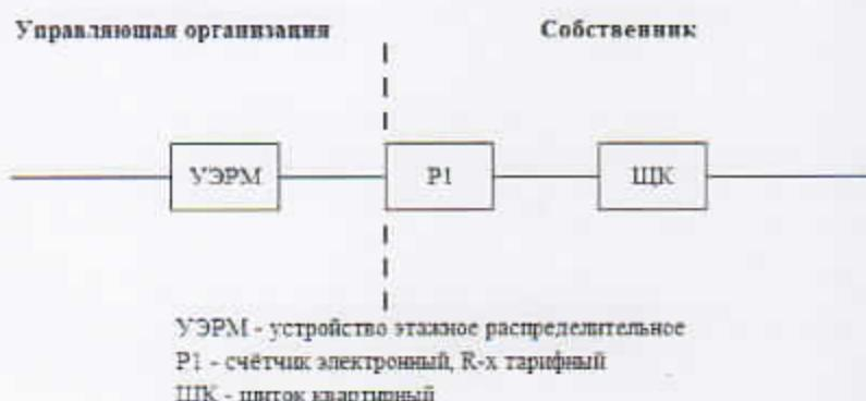
Исполнитель несет ответственность за надлежащее состояние и работоспособность питающих электрических сетей на квартиру согласно изложенной схеме до прибора учета (пустырной линии слева).
