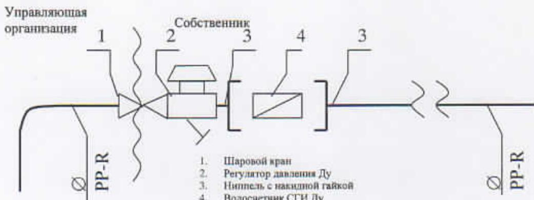
Исполнитель несет ответственность за надлежащее состояние и работоспособность систем горячего и холодного водоснабжения согласно изложенной схеме до волнистой линии слева (включая шаровой кран).
